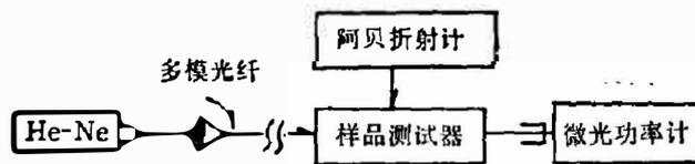
图5 传输系数与温敏探头各参数关系测试装置
