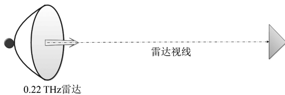
图 5 单个角反射器 RCS 测试场景示意图
