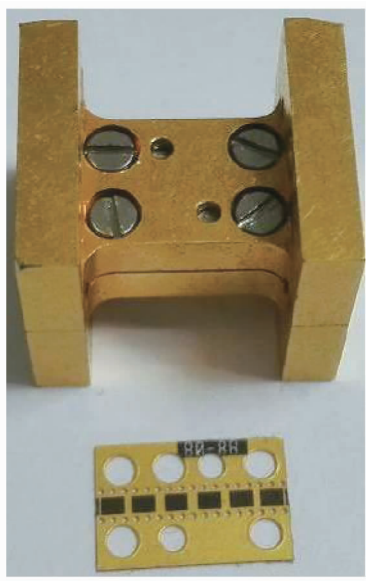
图 4 W 波段带通滤波器 Fig. 4 Photo of the W-band BPF
