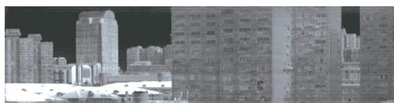
图 13 样机获取的热红外高光谱单波段图像(中心波长 9.5  $\mu\text{m}$ ,带宽 44 nm)
