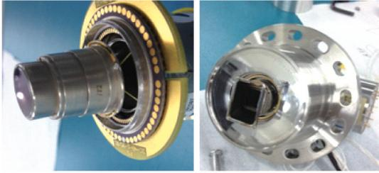
图5 热红外焦平面组件杜瓦设计及制造前后示意及照片(左:VLW RM4 标准组件杜瓦冷屏;右:针对高光谱设计特种杜瓦组件)
