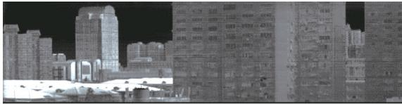
图 15 样机获取的热红外高光谱单波段图像(中心波长  $11.5\ \mu\text{m}$ , 带宽  $44\ \text{nm}$ )
