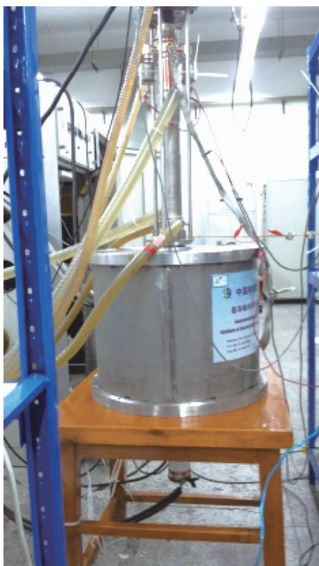
图 10 W 波段回旋行波管热测平台 Fig. 10 Hot test platform of W-band gyro-TWT
