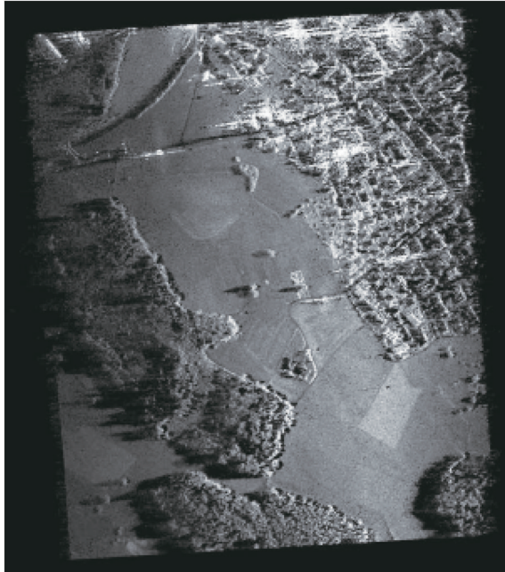
图2 MEMPHIS 雷达 Ka 波段 InSAR 技术合成图像(瑞士辛维尔地区)
