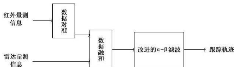
图1 毫米波 / 红外数据融合的改进的 \alpha-\beta 目标滤波跟踪系统的框图
