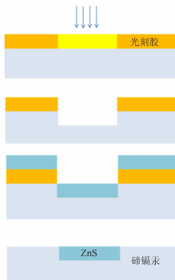
图 4 器件工艺流程图
