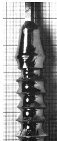
图 3 在晶体生长中滞后和非线性作用对等径控制的影响
