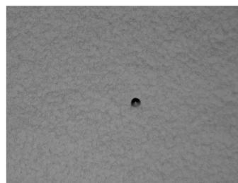
图 7 放大 100 倍的 InSb 位错腐蚀坑图片
