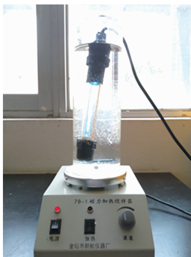
图 1 苯与过氧化氢光氧化实验装置图
