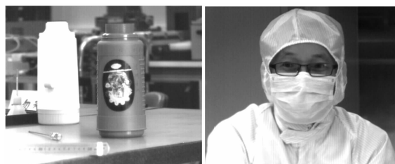
图 5 短波红外器件配置可见光镜头对物体及人体的成像结果
