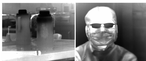
图 4 短波红外器件配置短波红外镜头对物体及人体的成像结果
