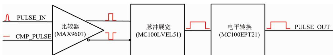
图 3 信号调理单元的电路结构
