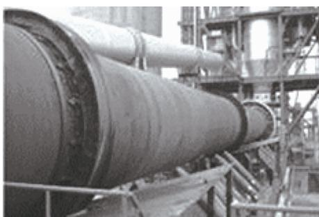
图 1 回转窑正常工作图
