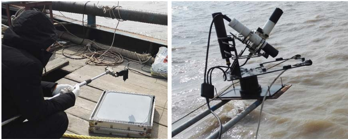
图 1 ASD 地物光谱仪与 Hyersas 海面光谱仪 (Lt 和 Lr 部分) 的工作现场
