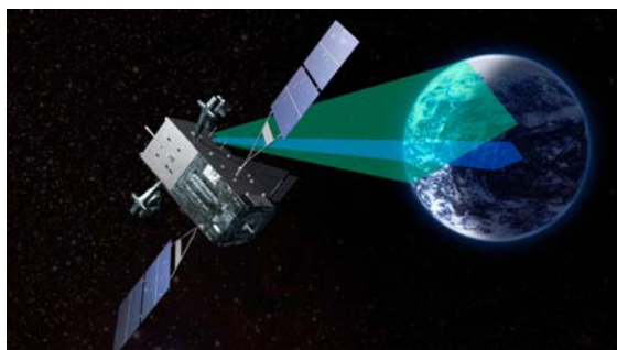
图 1 SBIRS GEO-5/6 卫星将采用 A2100 卫星平台
