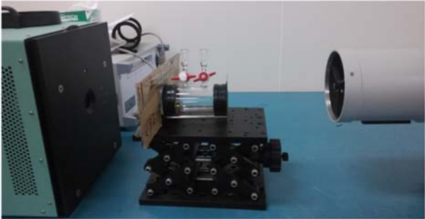
图 7 红外光谱辐射计波长标定的实验装置
