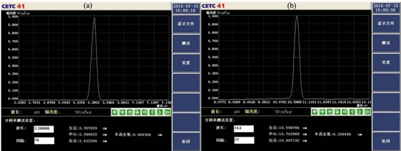
图 8 激光器校验结果: (a) 3.39\text{ }\mu\text{m} ; (b) 10.69\text{ }\mu\text{m}
