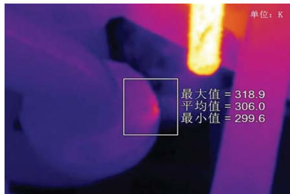
图 2 某船机舱的舱底管路热像图
