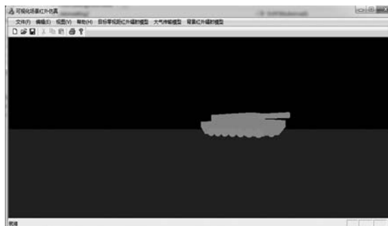
图 4 无云雨天气上午 9:00 的场景红外仿真 (考虑大气衰减作用, 8\sim 14\ \mu\text{m} )
