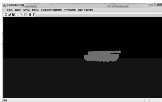
图 5 无云雨天气上午 9:00 的场景红外仿真 (考虑大气衰减作用, 3\sim 5\ \mu\text{m} )
