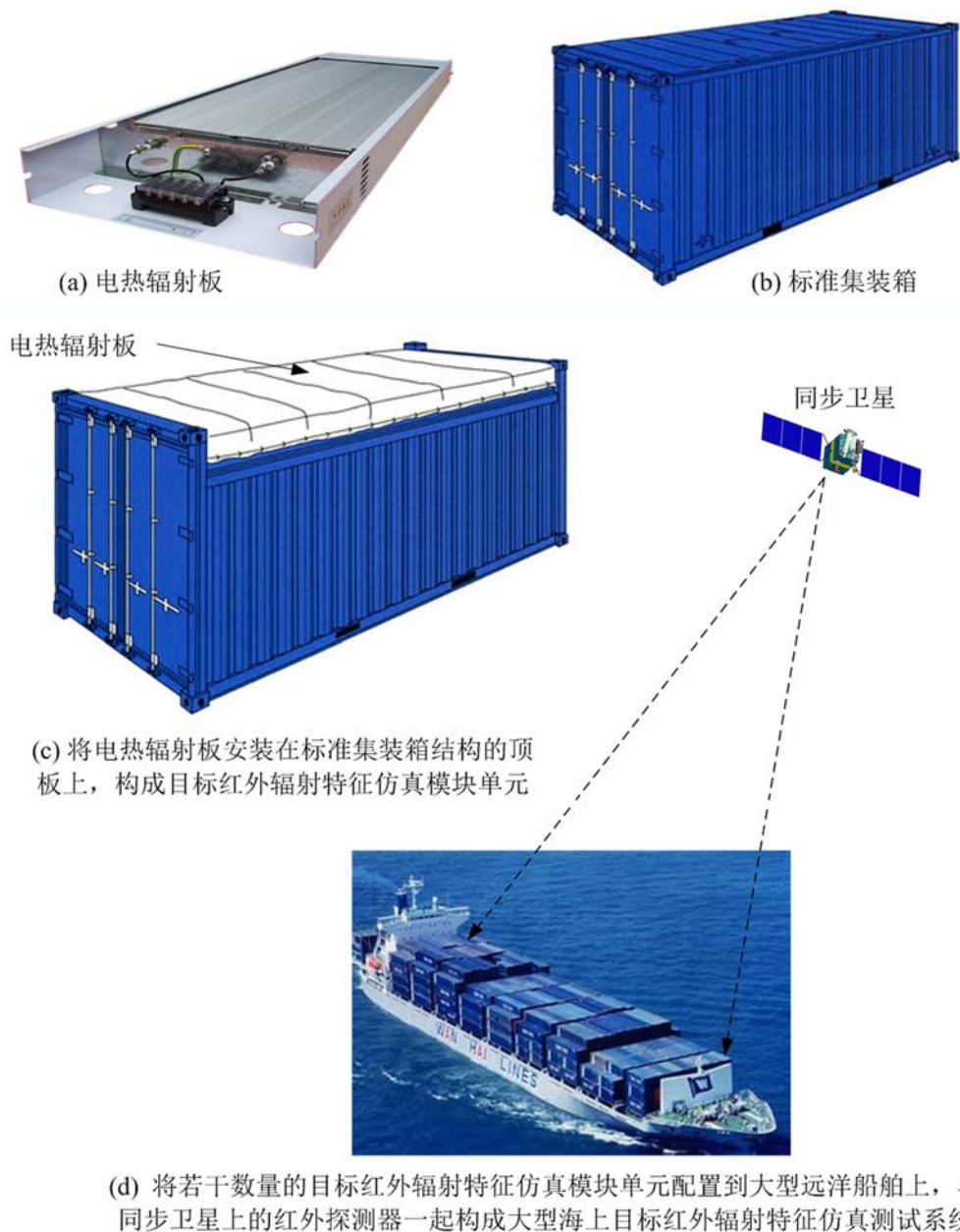
图 2 (a) 温度可调节的电热辐射板; (b) 标准集装箱结构; (c) 在集装箱顶板上安装电热辐射板, 构成目标红外辐射特征仿真模块单元; (d) 将若干数量的仿真模块单元配置到大型远洋船舶上, 与同步卫星上的红外探测器一起构成大型海上目标红外辐射特征仿真测试系统
