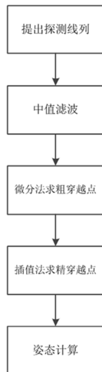
图 2 地平仪的数值仿真流程
