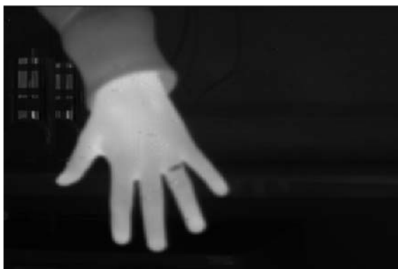
图 12 384 \times 288 相机凝视模式的成像图片
