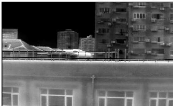
图 11 16 帧叠加 16 阶 TDI 的外景图像
