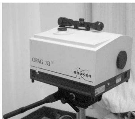
图 1 OPAG33 型傅里叶变换红外光谱仪
