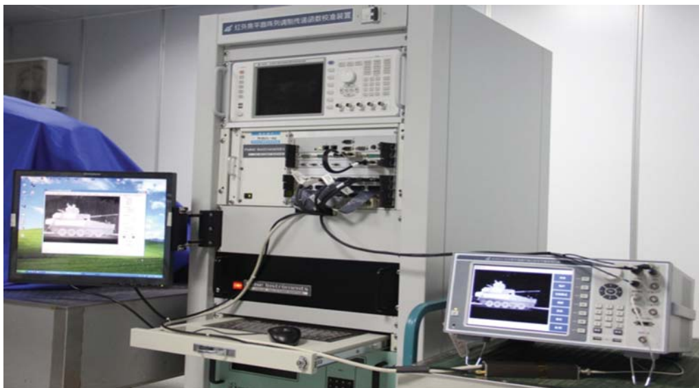
图 9 红外探测器模拟器模拟结果验证系统
