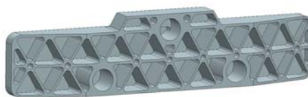
图 1 反射镜的轻量化结构
