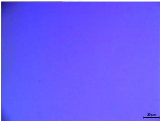
图 3 经硅溶胶 – 次氯酸钠化学机械抛光后的晶片表面的光学照片
