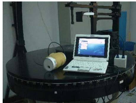
图 1 CE312-1b 热红外辐射计与 NENULGS 测量系统
