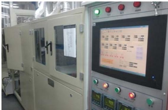
图 2 HgCdTe 外延材料的 ISOVPE 生长设备
