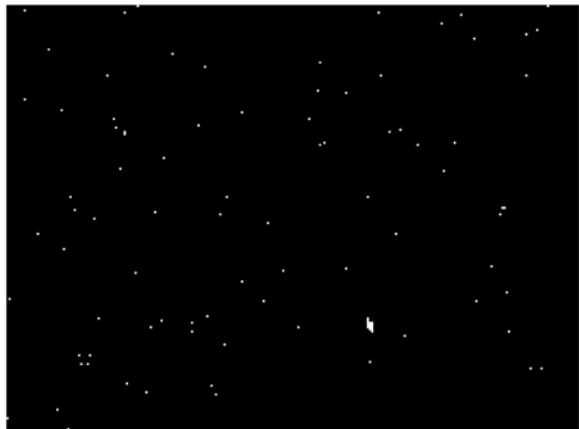
图 2 一帧红外图像经Átrous 小波变换处理后通过聚类算法分割得到的二值图像
