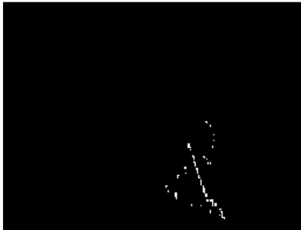
图 5 对 65 帧连续红外图像中点目标的运动轨迹进行跟踪的结果图
