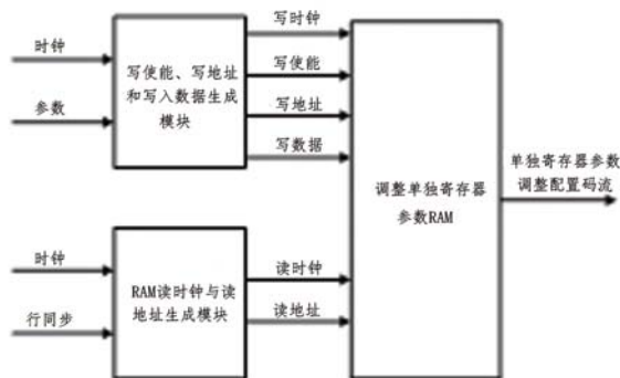
图 6 单独配置参数发送模块的逻辑流程图
