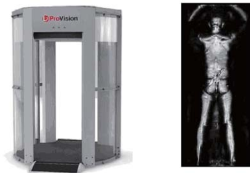
图2 L3毫米波人体成像设备及其成像效果
