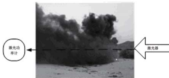
图1 单通道激光测红外烟幕透过率的方法
