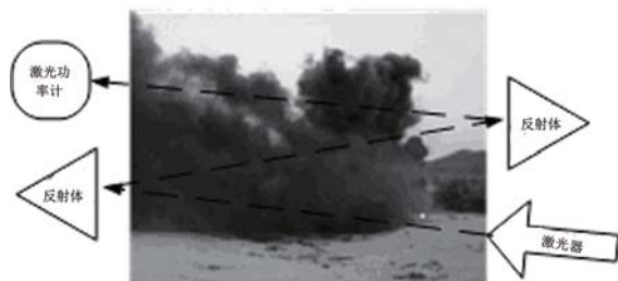
图 2 多通道激光测量红外烟幕透过率的方法
