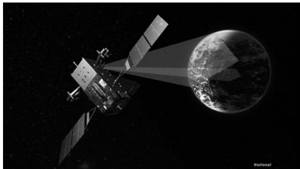
图 1 SBIRS GEO 卫星的概念图。与现有的预警卫星相比, 载有非常先进的扫描和凝视传感器的 SBIRS GEO 卫星具有更高的红外灵敏度和更短的重访时间。其中, 扫描传感器可以对全球导弹发射和自然现象进行广域监视, 而凝视传感器则可以出色的灵敏度对感兴趣的较小区域进行观测
