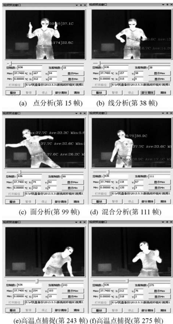
图 3 测温分析和高温点捕捉
