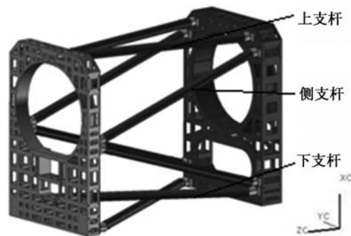
图1 机身结构及坐标定义
