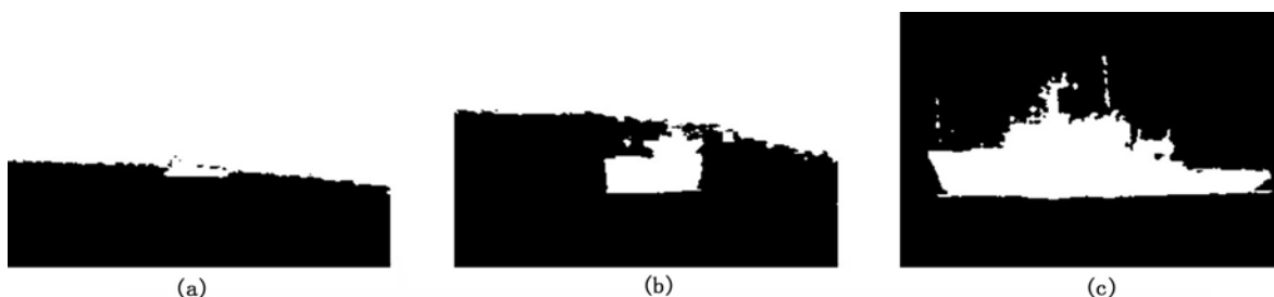
图 7 用 Otsu 方法分割后得到的二值图像
