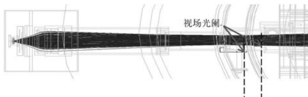
图 8 FY-2 辐射计红外光路中的红外杂散光
