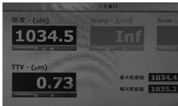
图 3 测厚仪测量的实验结果
