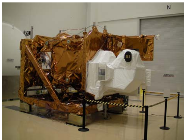
图 1 完成热真空测试后被安装在水平支撑架上的陆地卫星后续星 (来源: 轨道科学公司)
