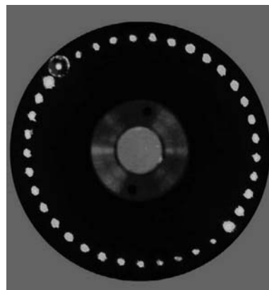
图 4(b) Herriott 池单个镜面上的光斑分布示意图
