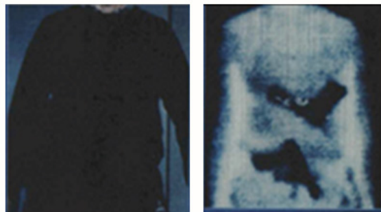
(a) 普通的光学图像 (b) THz 辐射成像结果 图 1 检测结果对比
