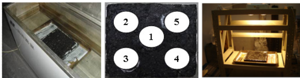
图 2 试件饱水、测温点布置和照射测温的示意图
