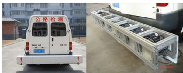
图6 沥青路面透水性红外差热检测仪整车
