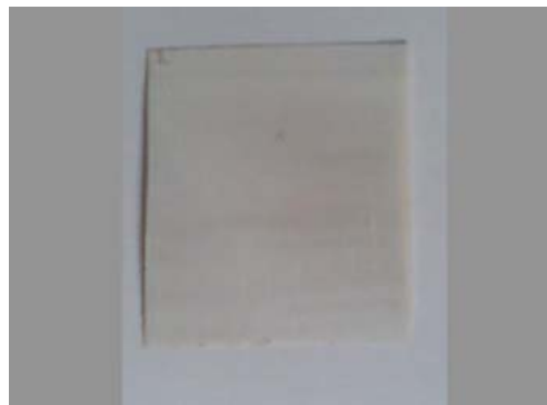
图 2 柔性 ITO 衬底上制备的 \text{TiO}_2 薄膜
