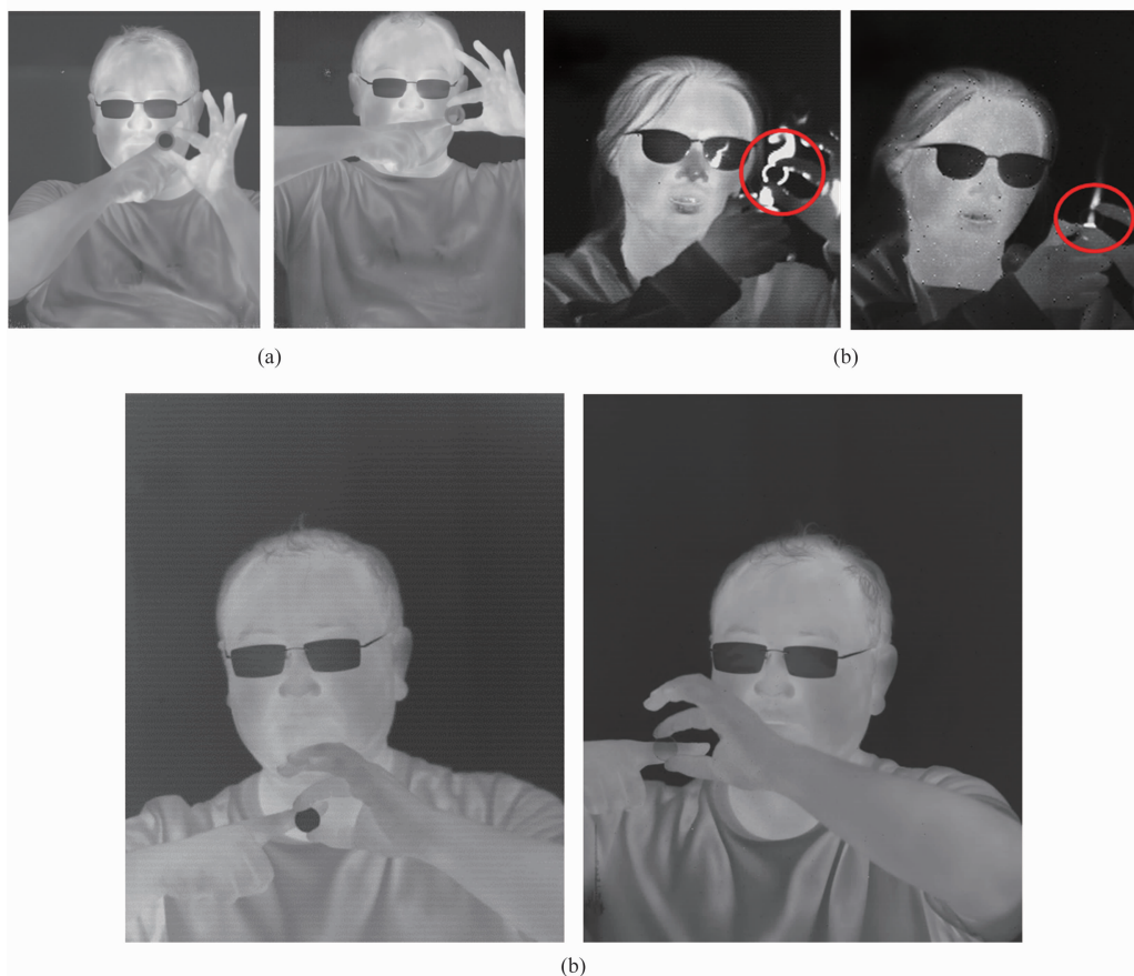
图 10 超晶格双色红外焦平面器件的成像图: (a)中波/中波; (b)中波/长波; (c)长波/长波
