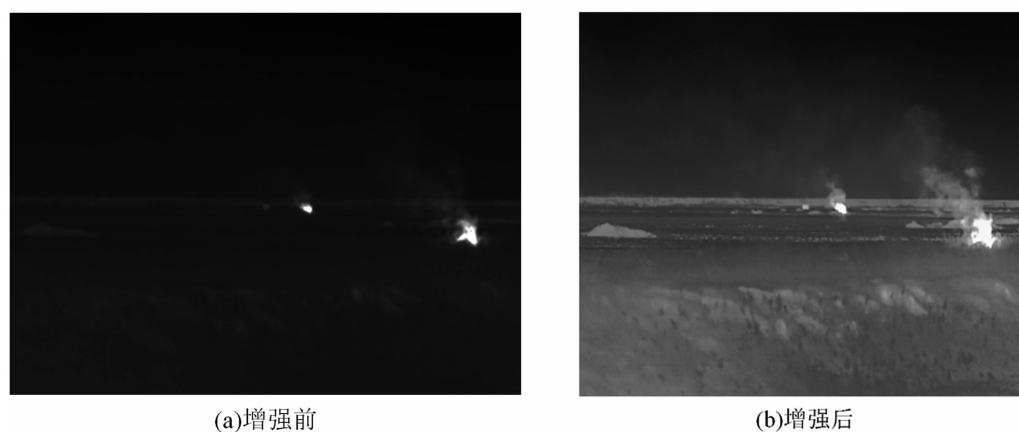
图 10 火光压制红外图像的增强效果
