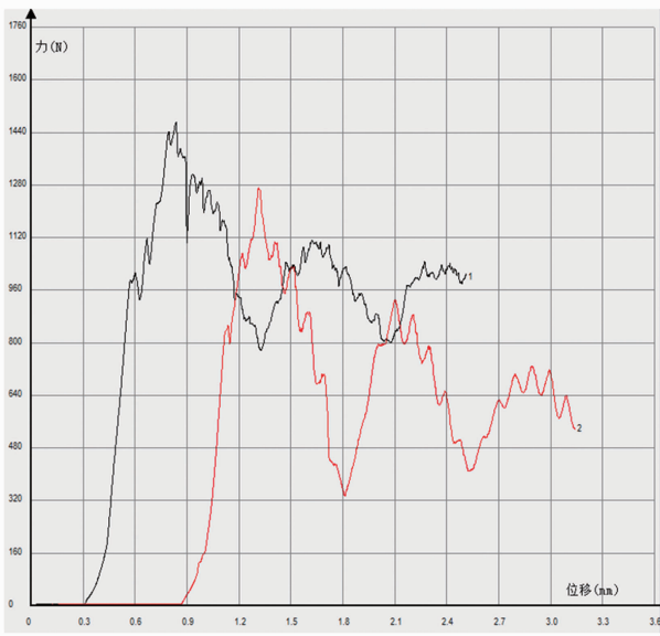
图 5 少涂胶磁钢组件的破坏力试验曲线
