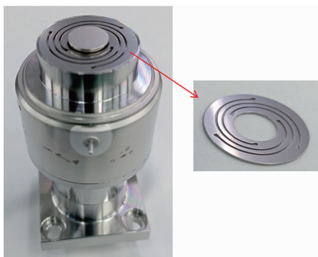
图 7 优化后杜瓦方案的实物图
