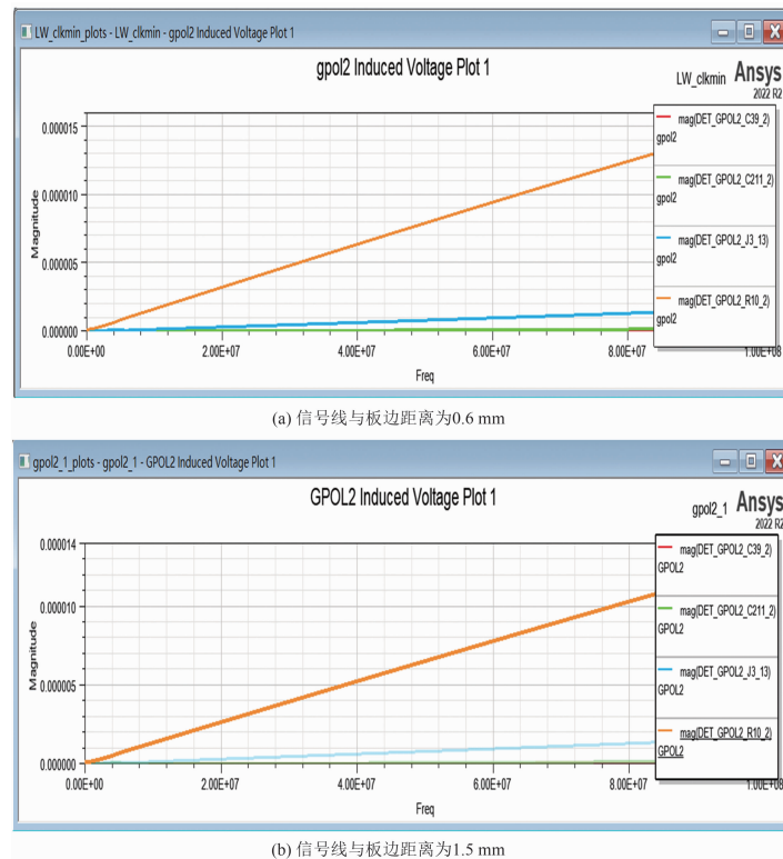
图 6 1 kHz~100 MHz 的空间磁场干扰情况下, 同一走线与板边距离为 0.6 mm 与 1.5 mm 时所产生的干扰电压
