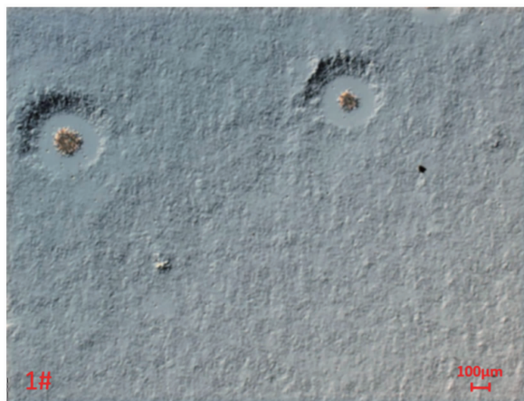
图 8 相同碲锌镉晶体在同一位置衬底(1#样品)液相外延后碲镉汞薄膜表面的类似“陨石坑”状缺陷
