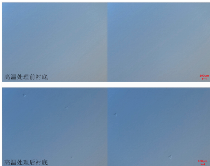
图 6 1# 样品在液相外延工艺前后的碲锌镉衬底同区域光学显微镜图像对照
