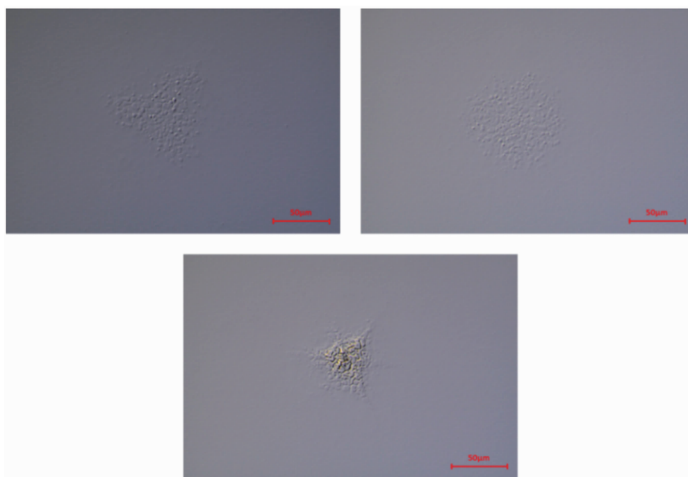
图 7 1# 样品在液相外延工艺过程中与碲镉汞生长溶液接触前表面异常区域的光学显微镜图像
