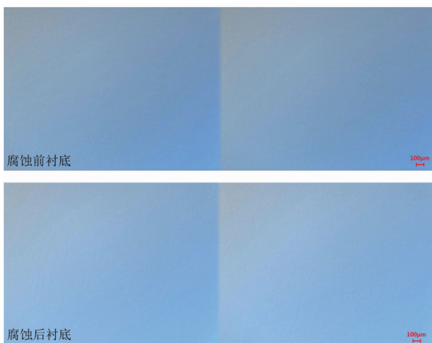
图 5 溴甲醇腐蚀前后碲锌镉衬底同区域的光学显微镜图像对照
