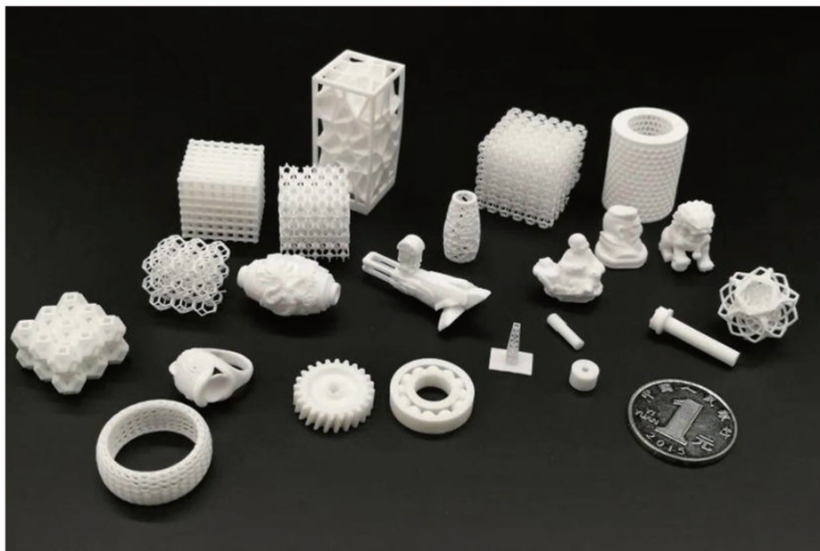
图 9 用 DLP 技术加工的复杂结构
