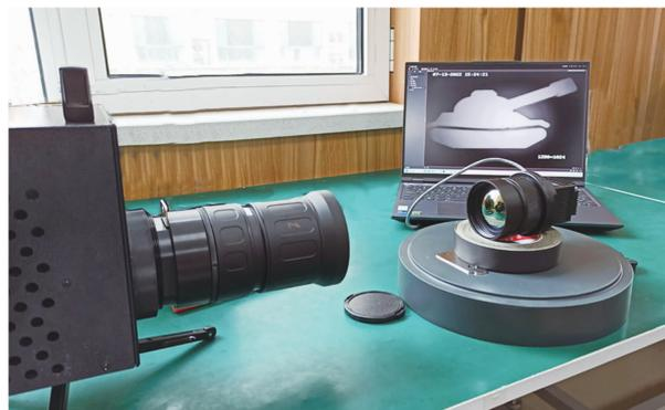
图 8 红外目标模拟器测试案例的实物图
